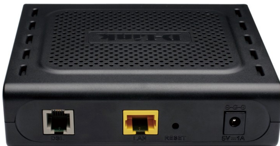
Рисунок 2. Вид задней панели DSL-2500U.
